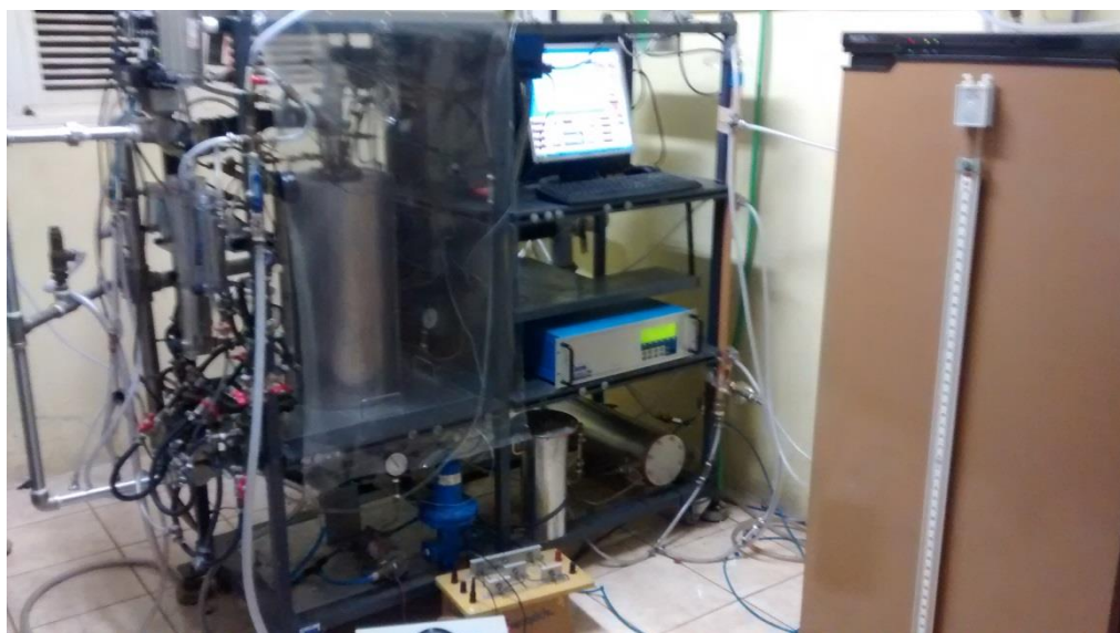
Figura 43 — Configuração da caldeira e instrumentos de medição
