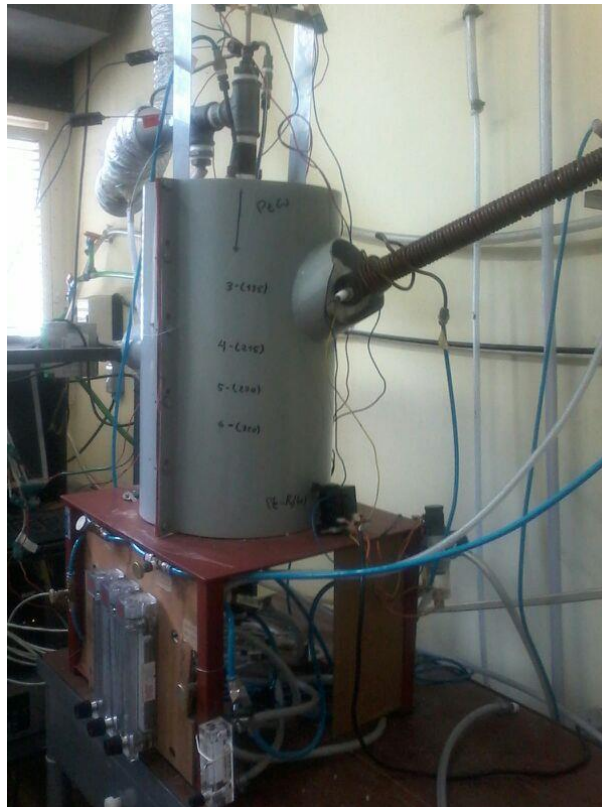
Figura 44 — Configuração do queimador poroso com lança-chamas
