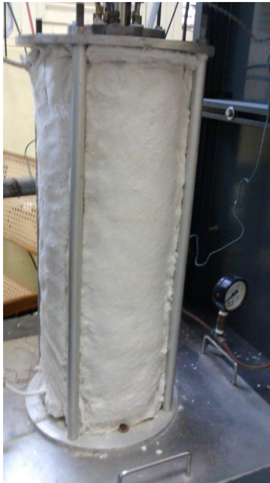
Figura 42 — Configuração da caldeira antes de ser fechada
