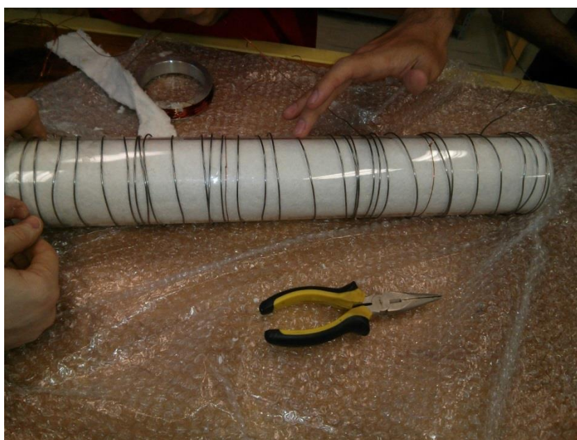
Figura 34 — Configuração do fio resistivo no tubo de quartzo
