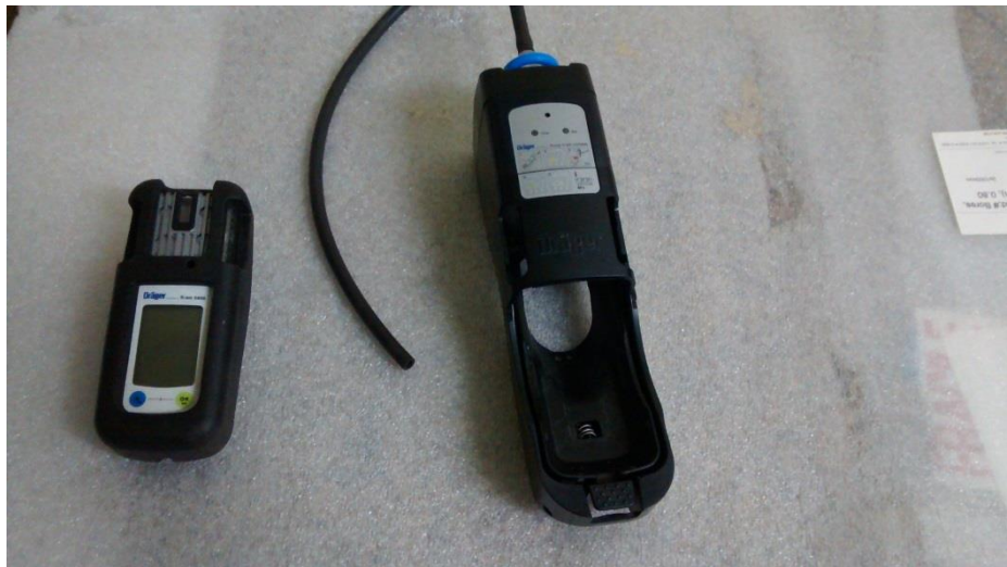
Figura 45 — Detector de gases Dräger
