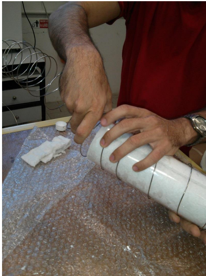
Figura 33 — Acoplamento do fio resistivo para aquecimento do meio
