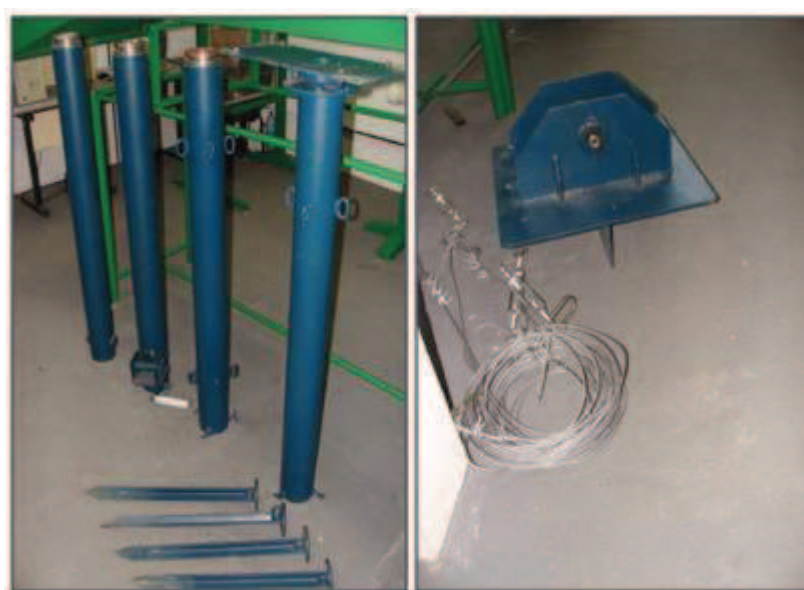
Figura 5.7 – blocos desmontáveis e base da torre. (Lopes, 2011)
