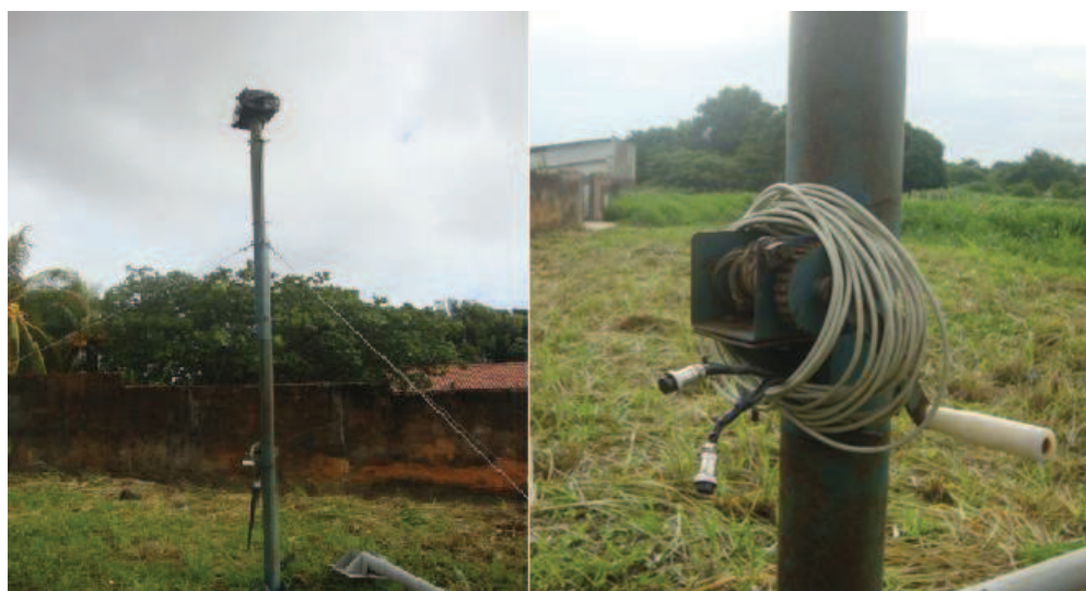
Figura 5.9 – Torre, fiação e alavanca de acionamento manual do freio.
