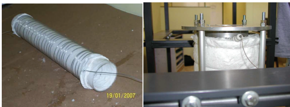
Figura 3.5 - Fotos do sistema de aquecimento utilizado na caldeira superadiabática instalada. (LACER)
