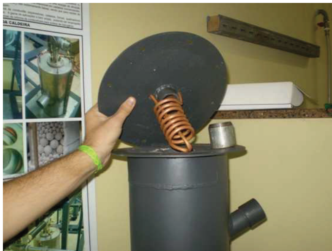
Figura 0.4 - Detalhe do trocador no flange.
