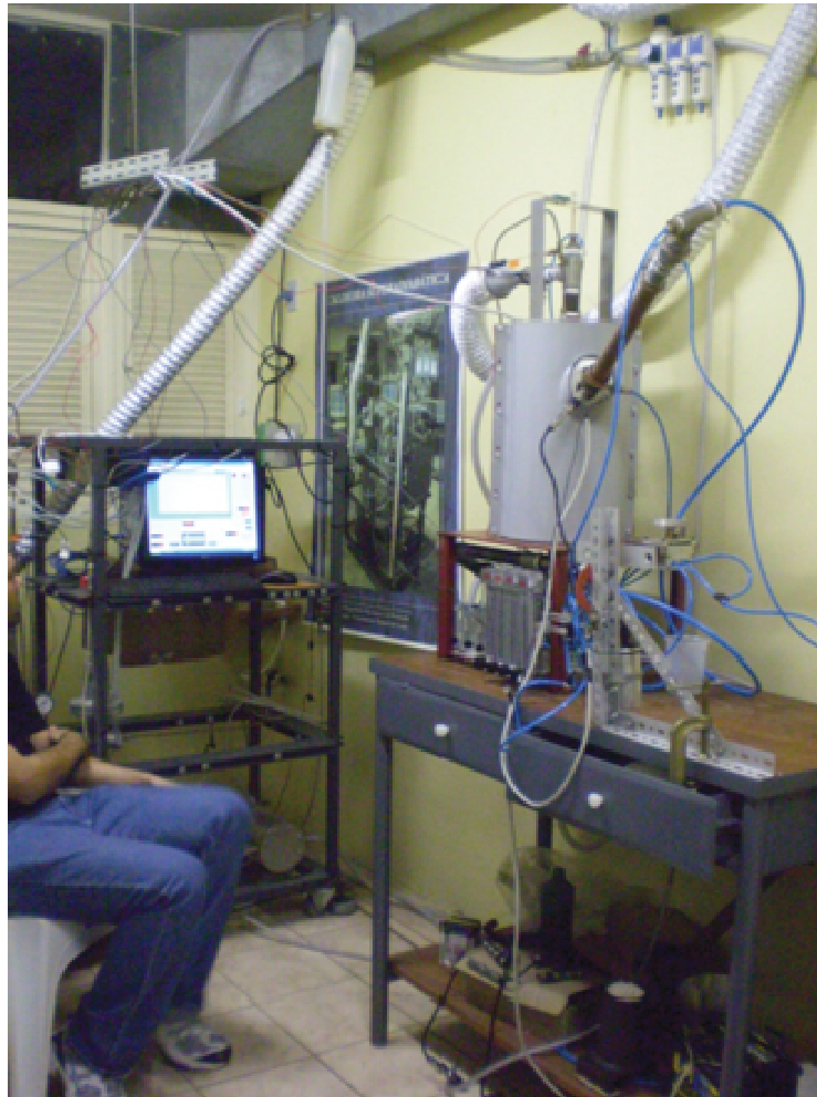
Figura 0.11 - Aquecedor com Sistema de Ignição Lança-Chamas em operação
