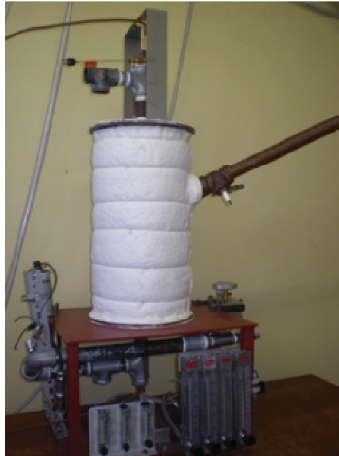
Figura 0.7 - Aquecedor na bancada de teste com isolamento e instrumentos
