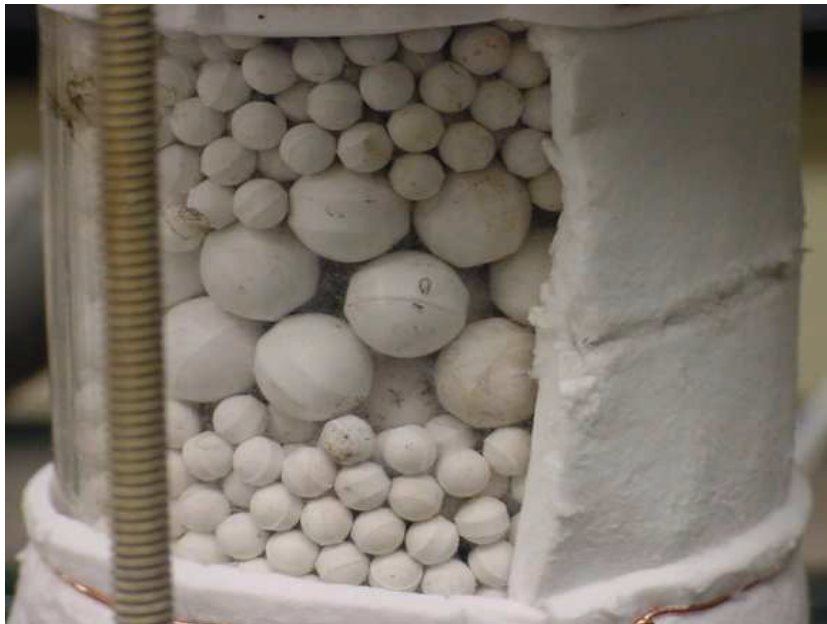
Figura 3.1 - Detalhe do Meio Poroso
