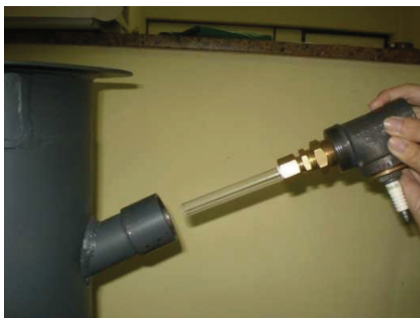
Figura 0.5 - Montagem do ignitor no aquecedor.
