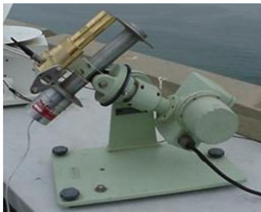
Figura 26 - Piroheliômetro para medir radiação direta
