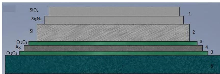
Figura 2 - Corte esquemático do observador seletivo: (1) camadas anti-refletoras; (2) absorvedor de silício; (3) barreira de difusão; (4) metal refletor; (5) substrato de aço inox (SERAPHIN, 1974)
