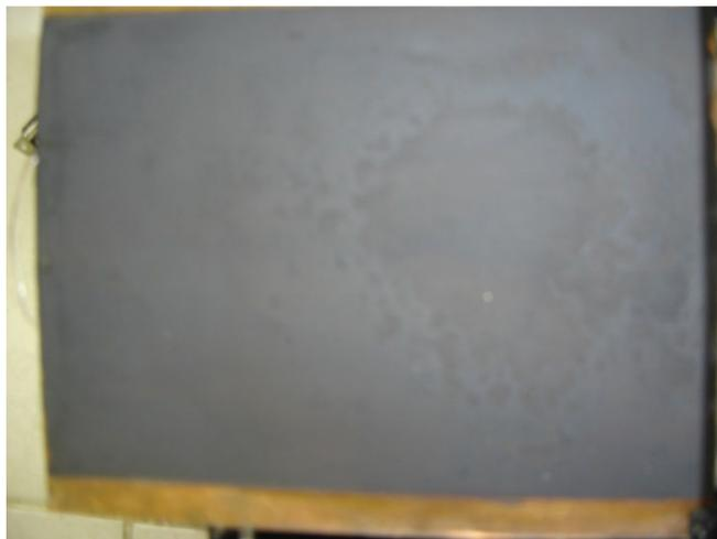
Figura 5 - Superfície de FCTO depositada sobre cobre e lixada
