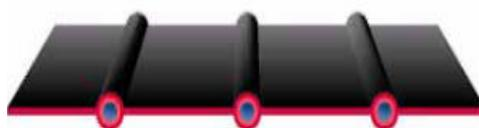
Figura 33- Absorvedor com sistema de tubos prensados entre duas chapas (SOLAR TÉRMICO, 2004)
