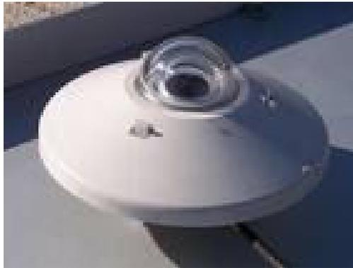
Figura 25 - Piranômetro para medir radiação global
