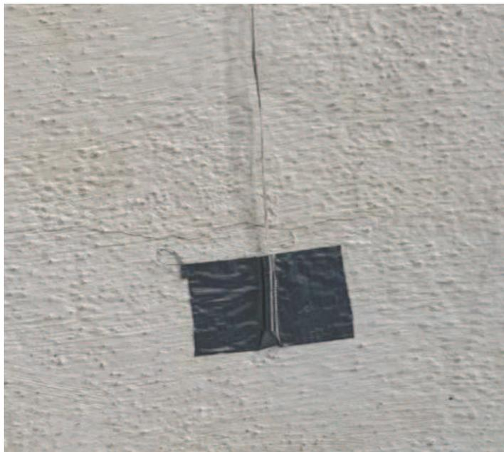
Já para a temperatura ambiente interna, Figura 23, os sensores PT-100 estão instalados no ponto mediano interno da edificação, a uma distância de 1,50 metros do teto e do piso. Dois sensores estão posicionados na parte interna que possui módulos FV e outros dois estão posicionados na parte da edificação que não possui módulos FV.
