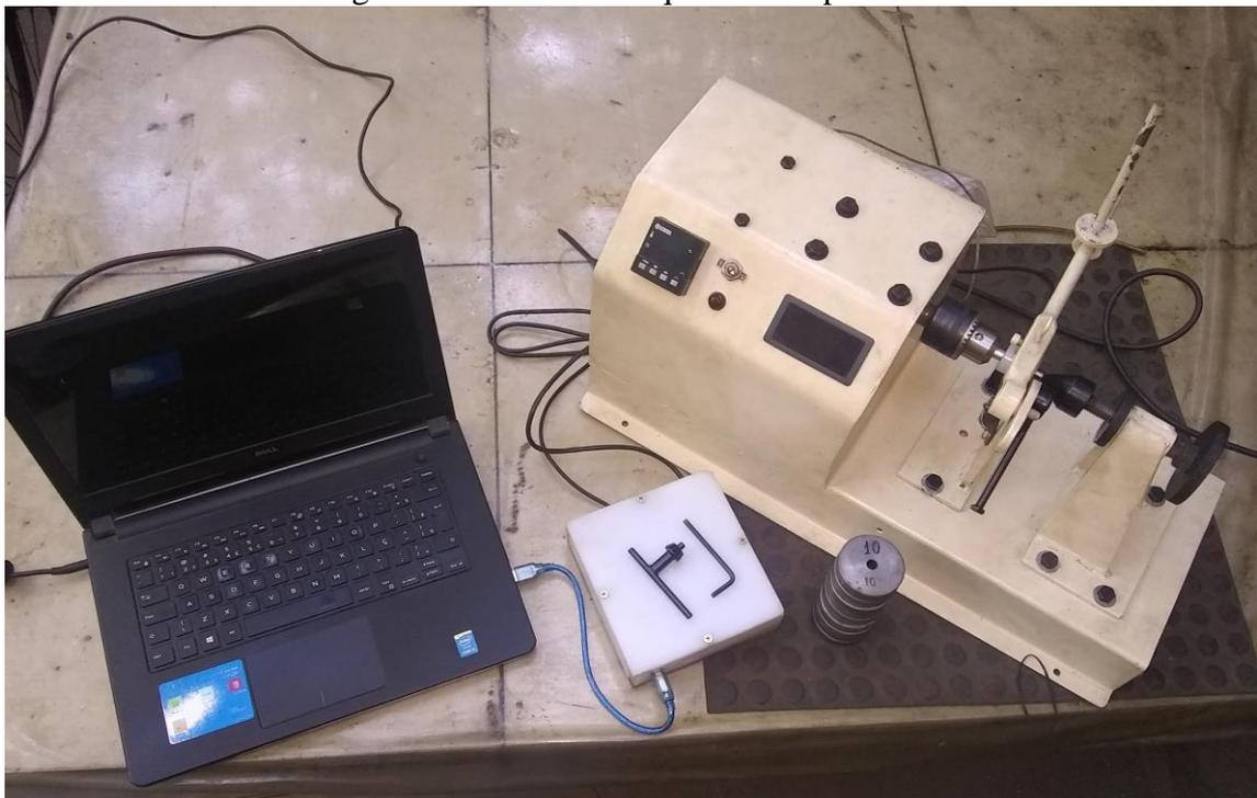
1° Passo: Conexão do cabo de sinal do sensor de torque. Na Figura 16A observa-se que o encaixe possui um guia para não ocorrer erros na ligação. O encaixe fica numa região aberta da máquina que é protegida por uma tampa de borracha Figura 16B. E uma conexão simples de se fazer. Figura 16C.
