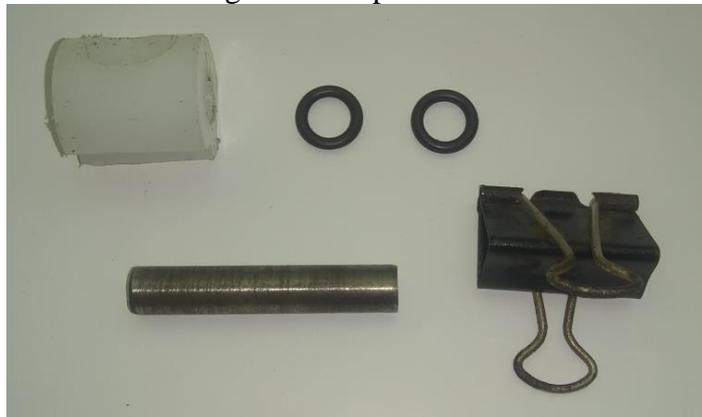
\* É um ajuste para esse reservatório de óleo, cuja finalidade é fazer com que o mesmo não entre em rotação junto com o corpo de provas rotativo.
