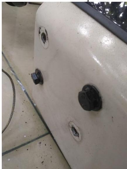
**Observação:** O eixo árvore possui o guia do sensor no qual seu acomplamento é uma rosca esquerda.
