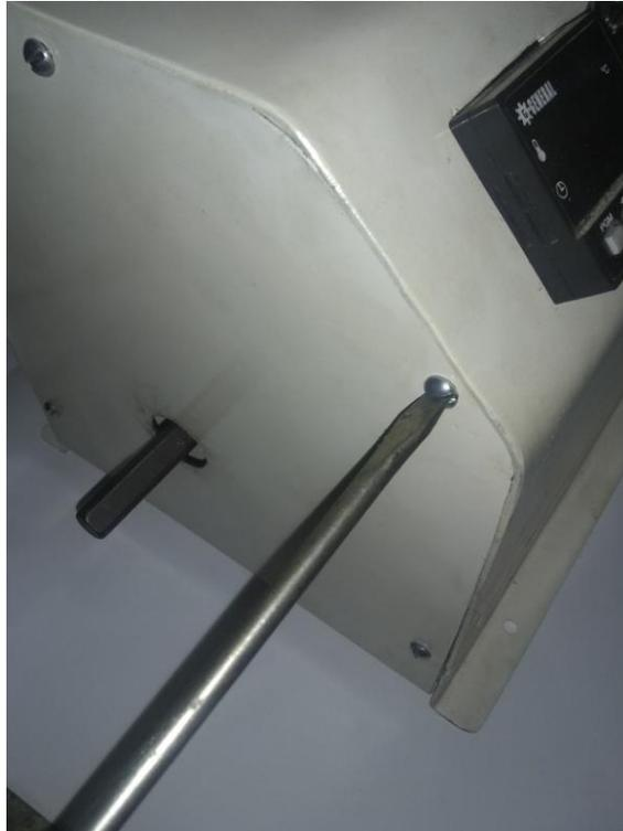
2º Passo: Deve-se retirar o controlador eletrônico para ter acesso ao sensor de o torque e assim começar a desmontagem.
