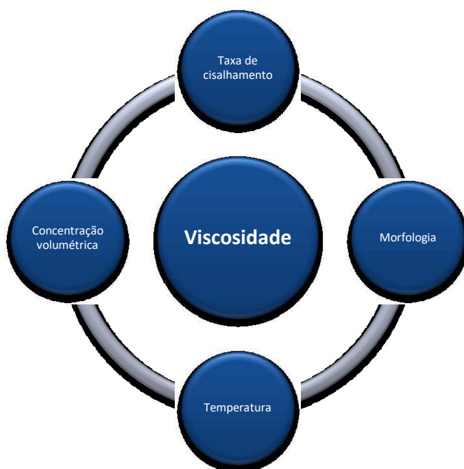
Figura 6 - Parâmetros que afetam a viscosidade dos nanofluidos
