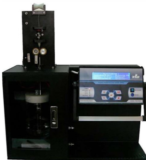
Figura 10 - Dispositivo utilizado para preparação de nanofluido em uma etapa (EEW)
