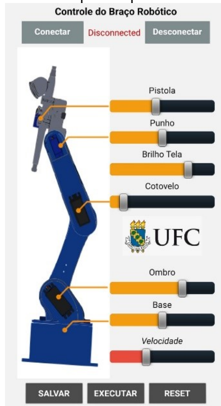
Figura 18 – Plataforma desenvolvida para o aplicativo controlador do braço mecânico.
