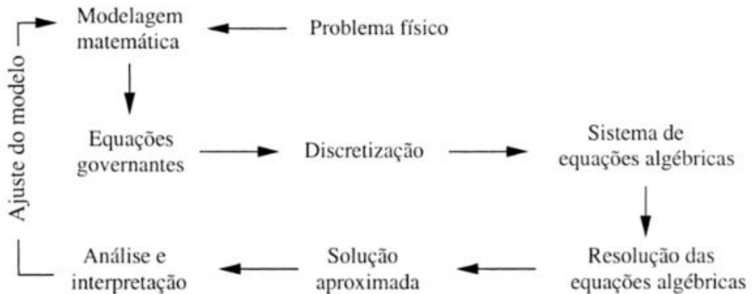
Figura 14 – Etapas para a obtenção da solução numérica de um problema de fluidos
