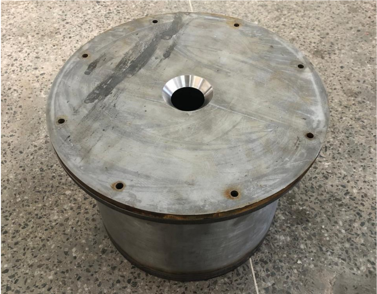
Figura 29 – Carcaça inox do receptor soldada e usinada
