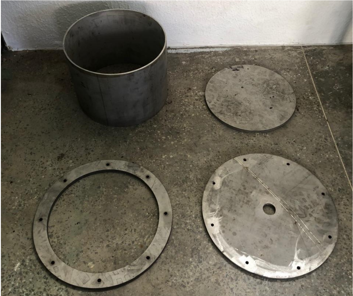
Figura 21 – Tubo e chapas do receptor
