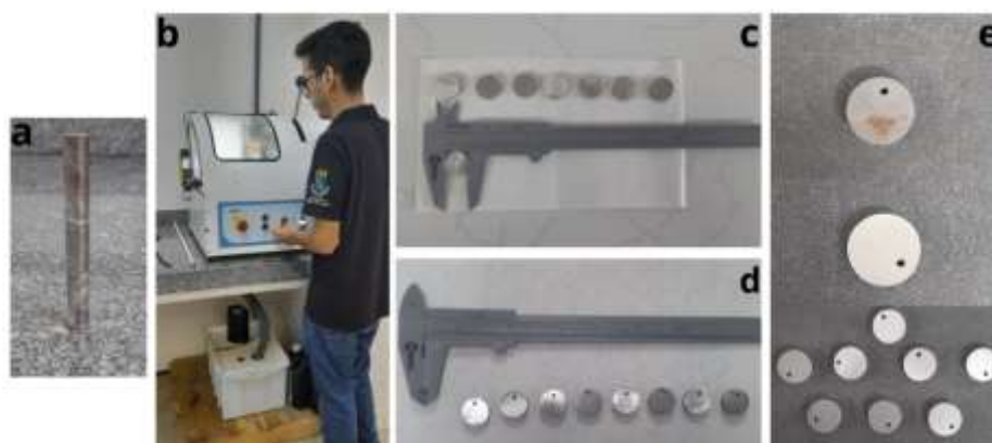
Figura 13 – Procedimento de preparação das amostras metálicas desde o corte até a perfuração do orifício de suspensão
