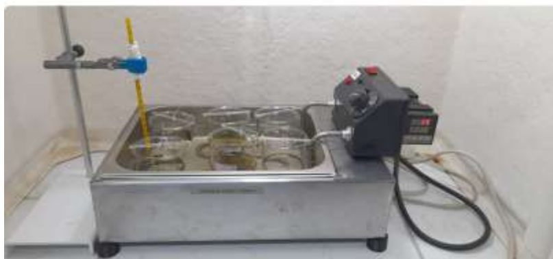
Figura 15 – Equipamento usado para os ensaios de perda de massa do aço carbono 4340 imerso em biodiesel de babaçu
