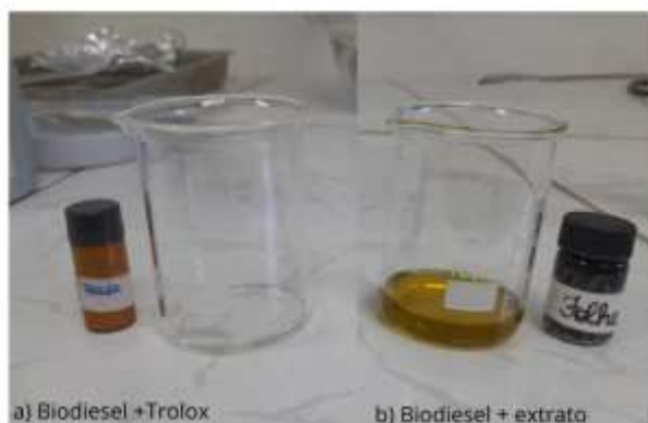
Figura 12 – Testes de solubilidade dos inibidores de corrosão em biodiesel de babaçu
